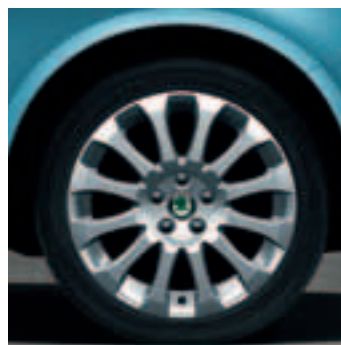
Легкосплавный колесный диск Comet (5J0 071 494); 6.5J x 16"; шины 205/45 R16
