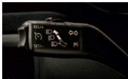
Устройство регулирования скорости (круиз-контроль) для всех версий двигателей для автомобилей с встроенным бортовым компьютером (ЗТО 035 623); для автомобилей без встроенного бортового компьютера (ЗТО 035 623А)
