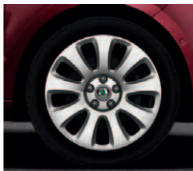
Легкосплавный колесный диск 7.5J x 17" Callisto шины 225/45 R17 (CCR 800 003)
