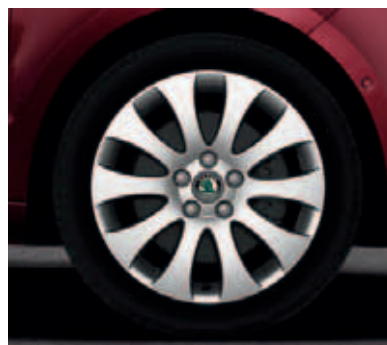
Легкосплавный колесный диск 7.0J x 17" Venus шины 225/45 R17 (CCR 800 002)
