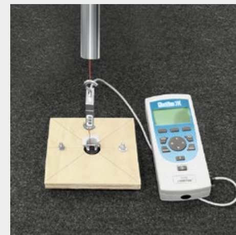
Тестирование прочности фиксаторов для ковриков
