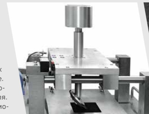
Устройство для «испытания каблуком»
