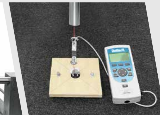
Тестирование прочности фиксаторов для ковриков
